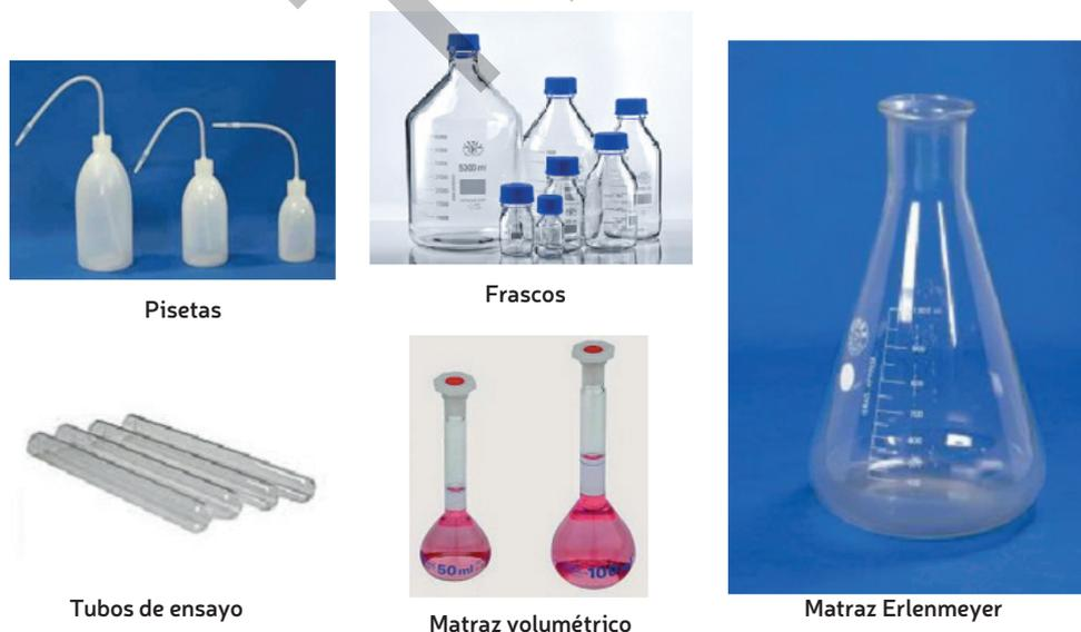
Figura 1.58 Pisetas, frascos, tubos de ensayo, matraz volumétrico y matraz de Erlenmeyer.
